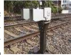
また、2020年から丹波橋通踏切道と京町踏切道において、2次元レーザーレーダー式障害物検知装置の本使用を開始しました。これは、踏切道内の一定の高さの平面と踏切道出入口の垂直方向にレーザーを照射する方式で、従来の装置より検知機能を高めています。
