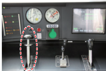
運転士異常時列車停止装置
