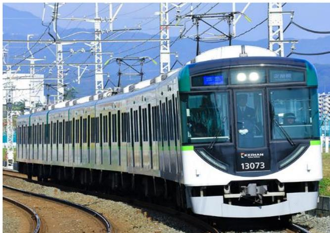
京阪電車 13000 系は、京阪線 2200 系、2600 系の代替用として新造した省エネルギー車両です。軽量なアルミ合金車体を採用しているほか、電力を効率よく利用する「VVVF（Variable Voltage Variable Frequency）インバータ制御装置」、「回生ブレーキ」などを導入しています。走行時の消費電力を従来車両（2600 系）との比較で約 35%削減し、「クリーン輸送」の実現に貢献します。
