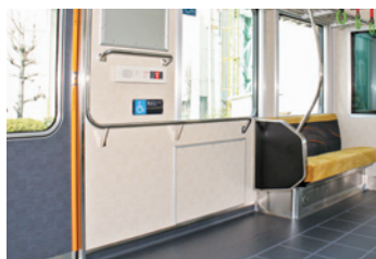
車いすスペース
