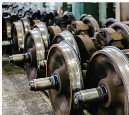
●踏面の削正作業で直径の小さくなってしまった車輪
