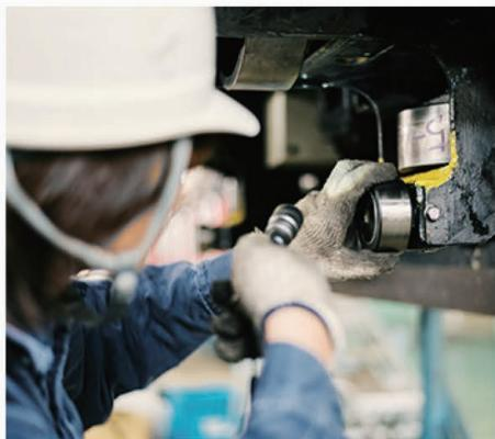
取材時は、組み立ての完了した車両の最終点検段階でした。テストハンマーとハンドライトを持ちボルトのゆるみがないか、打音検査を行います。もし万が一ゆるみがある場合は鈍い音がするそうですが、「カーンカーン」という引き締まった音が現場に響き安全を知らせます。
