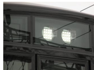
車内照明（写真上）と前部標識灯（写真下）にはLEDを採用
