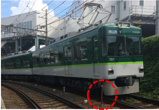
限界支障検知装置
