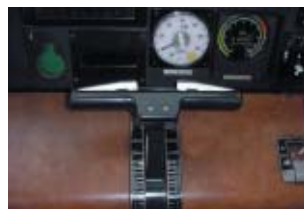
運転士異常時列車停止装置（手を離すと非常ブレーキが作動します）
