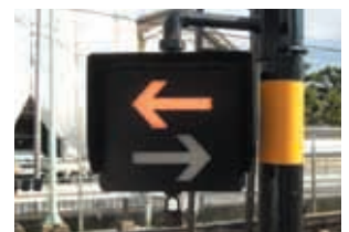
列車進行方向指示器(LED型)
